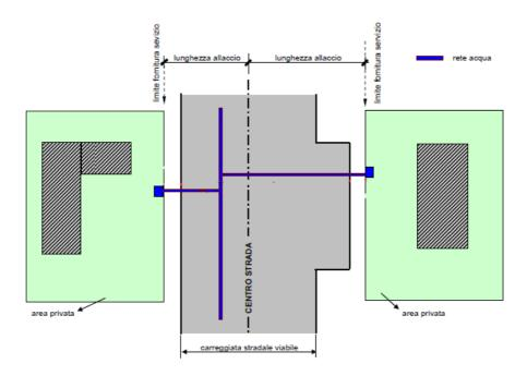
Le definizioni di Lunghezza di allacciamento (L) valgono solo in caso di condotta posta in sede stradale o posta ad una distanza non superiore a 1,5 metri dalla sede stessa,
