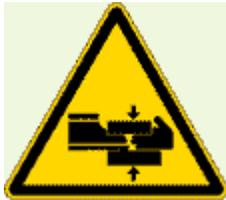
**Attenzione:** l'utilizzo del carrello a mano comporta il pericolo di urti o di schiacciamento alle estremità inferiori con un rischio residuo che è ritenuto non trascurabile. Pertanto è vietato utilizzare i carrelli a mano indossando calzature di tipo aperto (ciabatte, sandali infradito, etc.). È necessario indossare calzature chiuse (con tomaio), preferibilmente (in caso di utilizzatori professionali) "calzature di protezione" almeno di tipo P1.
